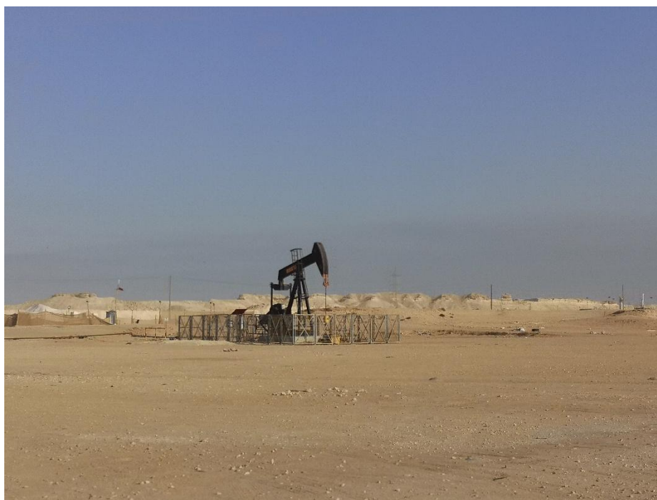
Immagine n. 17 - Pompa a cavalletto ( pumpjack ) per l'estrazione petrolifera onshore in Bahrein.
